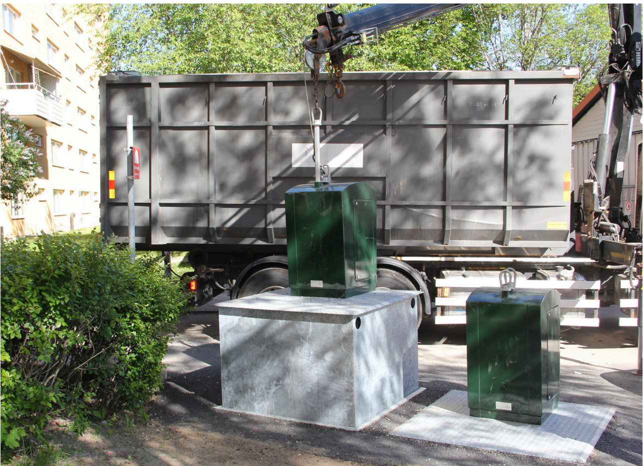
Tömning av underjordsbehållare. FOTO: TOMAS THERNSTRÖM, RAMBOLL
